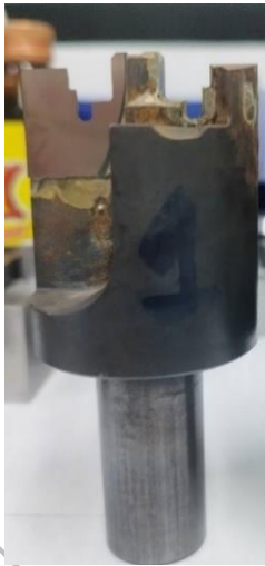
ภาพที่ 7 มีดกลึง CT-15 ด้านบ่าซีลที่ผ่านกระบวนการ Reuse
