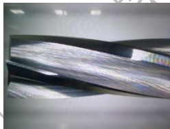
ภาพที่ 22 เครื่องมือตัดที่ผ่านการทำความสะอาดด้วยเครื่อง อัลตราโซนิกตามแผนการซ่อมบำรุงใหม่
