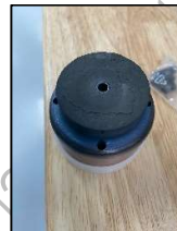
ภาพที่ 5 สภาพพลาสมาบูสเตอร์ที่ใช้งานเกินจำกัด
