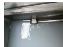
ภาพที่ 14 หัวพ่นน้ำเพื่อกำจัดคราบน้ำมัน เอียงไม่ ขนานกับผิวน้ำ
