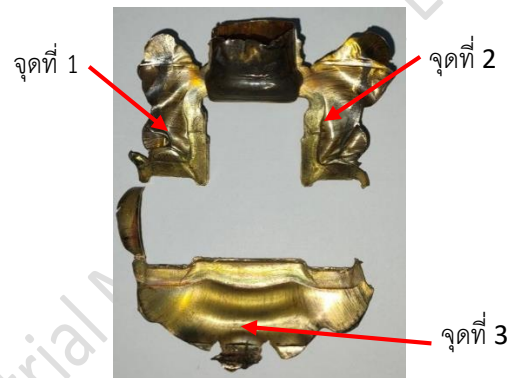
ภาพที่ 3 ลักษณะครีบ(Flashing)ของชิ้นงาน BV15 MINI
