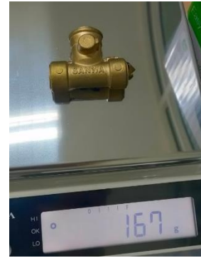
ภาพที่ 2 ชิ้น BV15 MINI (3w) หลังปั๊มขึ้นรูปและตัดครีบ
