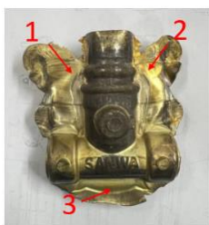
ภาพที่ 9 ชิ้นส่วนบอลวาล์วที่ผ่านการปั๊มและมีครีบบท
