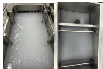
ภาพที่ 20 เครื่องแยกน้ำมันมีการไหลเวียนของน้ำเพื่อแยกคราบน้ำมันตลอดเวลา
