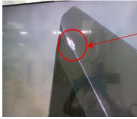
ภาพที่ 1.8 ชิ้นงานมีดกลึงทั้งสแตนคาร์ไบด์แตกระหว่างขัดผิวชิ้นงาน
