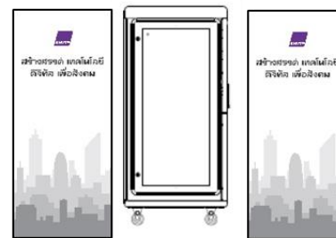
ติดตั้งฝาข้าง ฝาหน้า หลัง เข้ากับตัวเครื่อง
