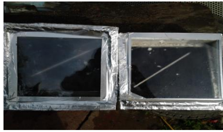
ภาพที่ 1 ต้นแบบเครื่องกลั่นน้ำที่ใช้กระจกสุญญากาศและแบบใช้กระจกใส
