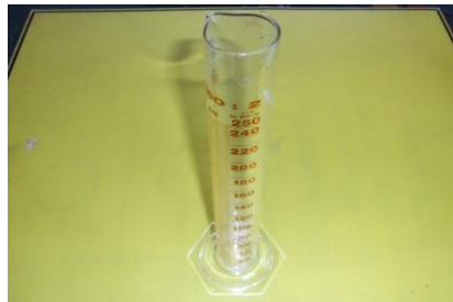
ภาพที่ 3 บีกเกอร์สำหรับตวงปริมาณน้ำที่กลั่นได้ต่อชั่วโมงขนาด 20-250 มิลลิลิตร
