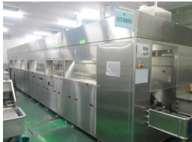
ภาพที่ 3 เครื่องล้างทำความสะอาดชิ้นงาน (Aqueous Washing; AQW)
