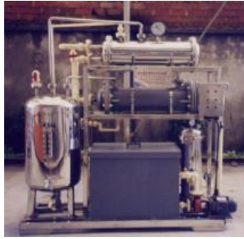
ภาพที่ 6 แสดงลักษณะของเครื่องกลั่นแบบสุญญากาศและเมมเบรน ที่มา : www.Elsevier.com/Locate/desal
