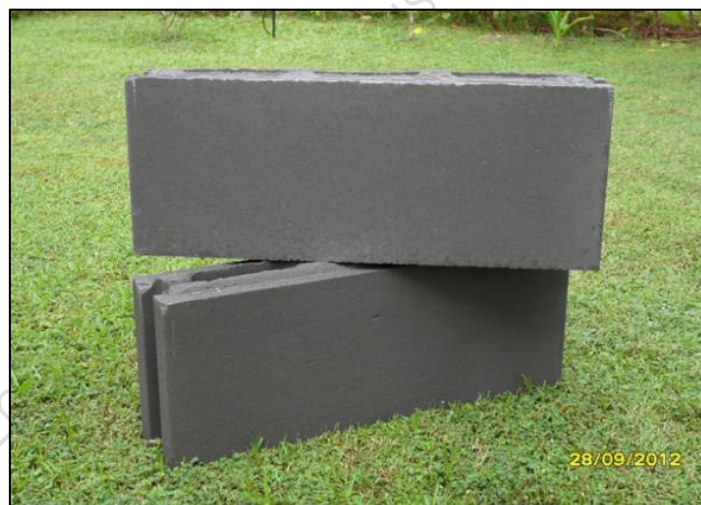
ภาพที่ 5 แสดงคุณภาพพื้นผิวความเรียบของบล็อกคอนกรีตที่ได้พัฒนาขึ้น
