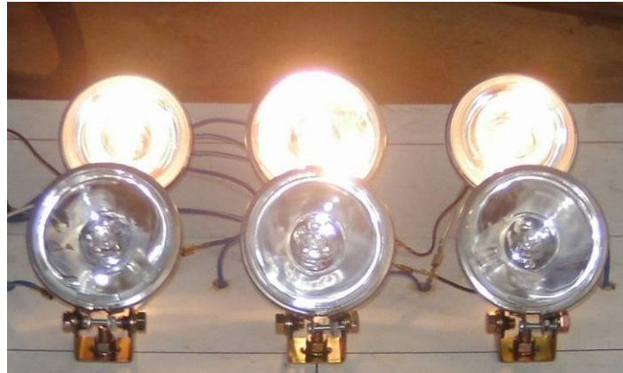
ภาพที่ 4 โหลดหลอดไฟฟ้า DC ขนาด 24 V @70 W
