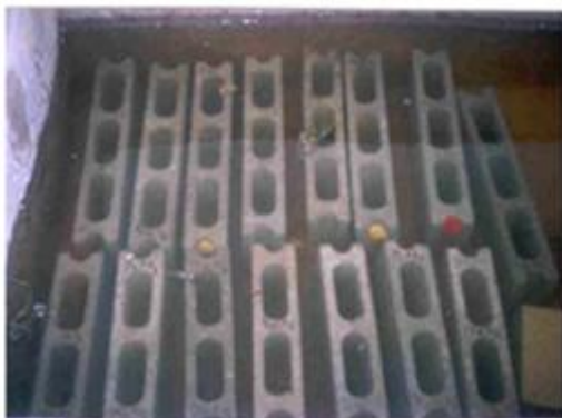
ภาพที่ 1 แสดงการทดสอบร้อยละการดูดกลืนน้ำ
