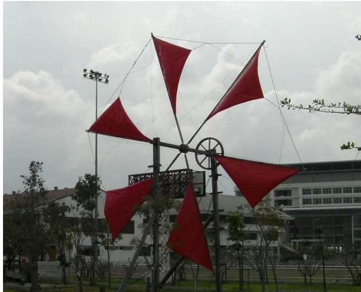
ภาพที่ 2 กังหันลมผลิตไฟฟ้าและสูบน้ำความเร็วรอบต่ำแบบใบผ้า มหาวิทยาลัยเทคโนโลยีราชมงคลธัญบุรี
