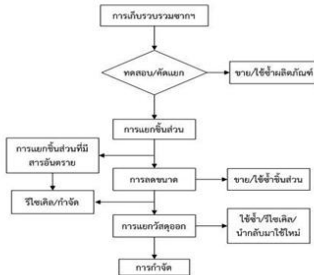
ภาพที่ 2 กระบวนการรีไซเคิลซากผลิตภัณฑ์เครื่องใช้ไฟฟ้าและอิเล็กทรอนิกส์ ที่มา: ปรับจาก E-waste Management Manual, 2007 [8]
