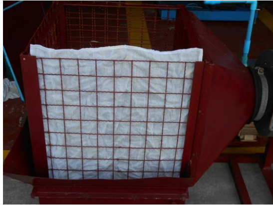
ภาพที่ 3 แผ่นซับน้ำที่ทำจากมุ้งกันยูง
