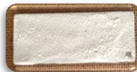
ภาพที่ 2 สภาพที่ได้จากการเคลือบซิงค์ออกไซด์และซิงค์ออกไซด์ผสมตัวประสานลงบนแผ่นสังกะสี
