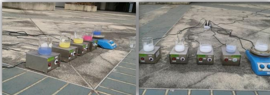
ภาพที่ 2 ภาพก่อนและหลังการย่อยสลายสีย้อมผ้าประเภทต่าง ๆ โดยซิงค์ออกไซด์ขนาดไมโครเมตรที่ได้รับความอนุเคราะห์มาจากบริษัท ไทย-ไลซาท จำกัด (ตำแหน่งการจัดวางบีกเกอร์มีการสลับกัน 1 คู่จากปัญหาที่เกิดกับเครื่องกวน)
