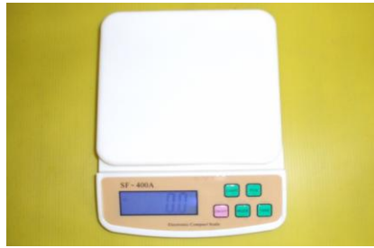
ภาพที่ 2 เครื่องชั่งปริมาณน้ำที่กลั่นได้ต่อชั่วโมง รุ่น SF- 400A
