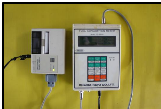
ภาพที่ 2 แสดง Fuel Consumption Meter รุ่น OKUDA Fc 9500
