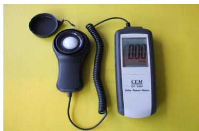
ภาพที่ 1 Solar Power Meter รุ่น DT-1307
