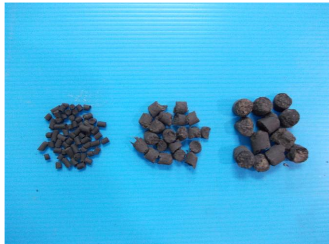
ภาพที่ 1 วัสดุปลูกอัดเม็ดจากกากตะกอนหม้อกรองผสมกับซีเมนต์ขาวอ้อย ขนาด 4 8 และ 12 มม. (เรียงจากซ้ายไปขวา)
