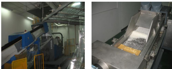
ภาพที่ 7 เทคโนโลยีเอ็กซ์ทรูชั่น-แกรนูลเรท (Extrusion granulate) เครื่องรีไซเคิลพลาสติก
